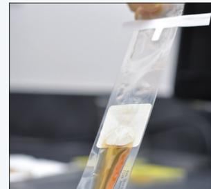
Retirer la poche du sac et déplacer manuellement le liquide afin que l'intégralité du liquide se trouve dans la chambre inférieure. Ouvrir la poche en déchirant la partie supérieure. Elle est prédécoupée de sorte à faciliter l'ouverture. Utiliser les languettes blanches sur toute la longueur pour ouvrir et fixer l'entrée de la poche.
