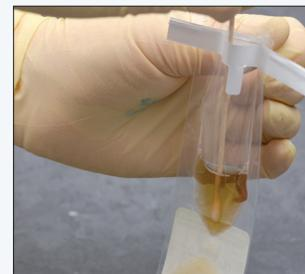
Insérer l'échantillon dans la chambre supérieure de la poche (échantillon de 0,5 à 1,0 ml). Presser une petite quantité de liquide de la chambre inférieure vers la chambre supérieure de la poche afin de rincer l'échantillon. Limiter l'introduction de bulles ou de mousse. Jeter la pipette et la seringue.
